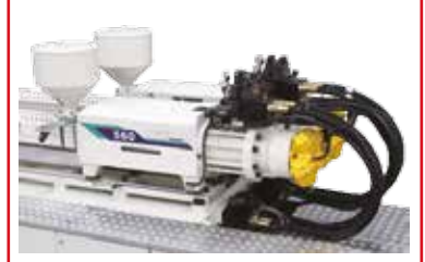
Tek silindirli enjeksiyon tekraralama kabiliyetini artırır ve hızlı tepkime sağlar. Single-cylinder injection increases repetition capability and provides fast reaction.
