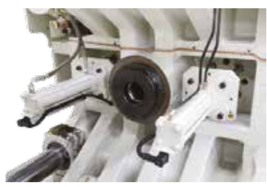
Bağımsız çift itici silindir kontrolü. Independent double pusher cylinder control.
