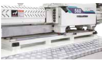
Enjeksiyon tarafı kızak sistemi titreşimi önler. Injection side skid system prevents vibration.
