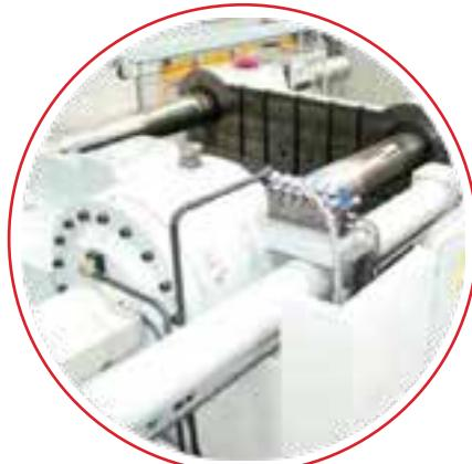
Uzun vida plastikleştirme kabiliyeti artırır. Hızlı mal alma ve enjeksiyon imkânı verir. Sistem asenkron çalışan çift silindir sistemine göre daha iyi sonuç verir.
