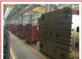
Fabrikamızın talaşlı imalat bölümünden bir görünüm. Yüksek hassasiyete sahip Japon Okuma ve Mitsubishi CNC tezgahlar özel döküm parçaları işlerken. Döküm parçalar bir yıl bekletilerek iç gerilmeler minimum seviyeye indirilmiştir.
